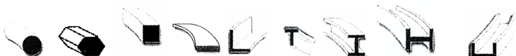
Hierros: redondo, hexagonal, cuadrado, planchuela, ángulo o L, T, I, H, U
