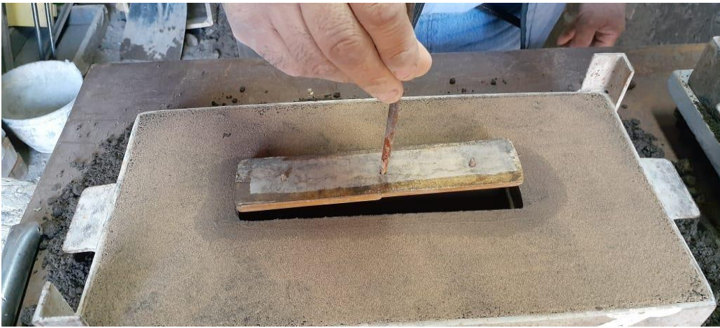
10- A cuatro centímetros del costado del molde debemos perforar con el sacabocado.
