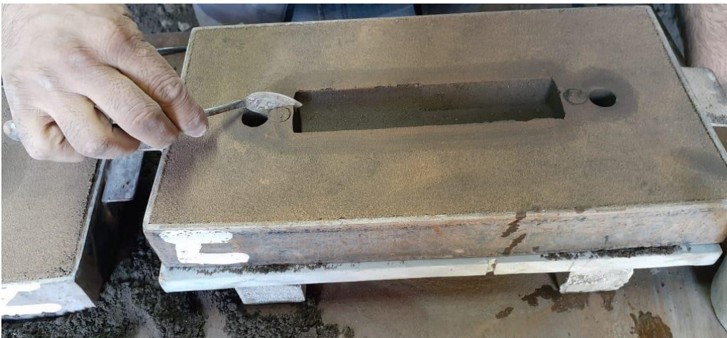
11- Del ancho del sacabocado hacemos canaletas que une el agujero del sacabocado y el molde.
