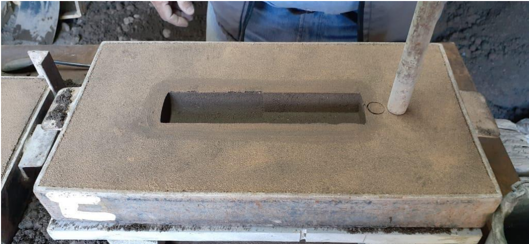
11- Del ancho del sacabocado hacemos canaletas que une el agujero del sacabocado y el molde.
